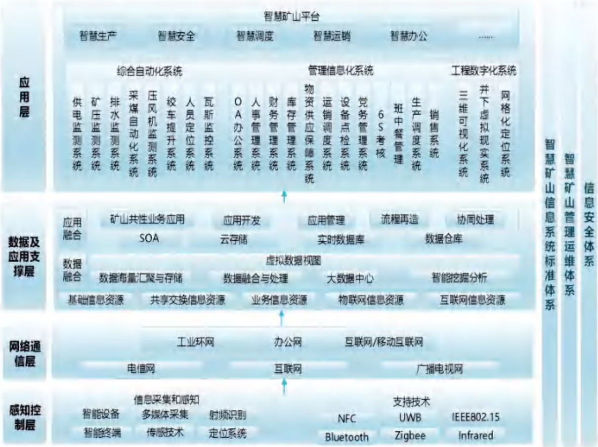
图 1 智能化煤矿技术体系总体架构
