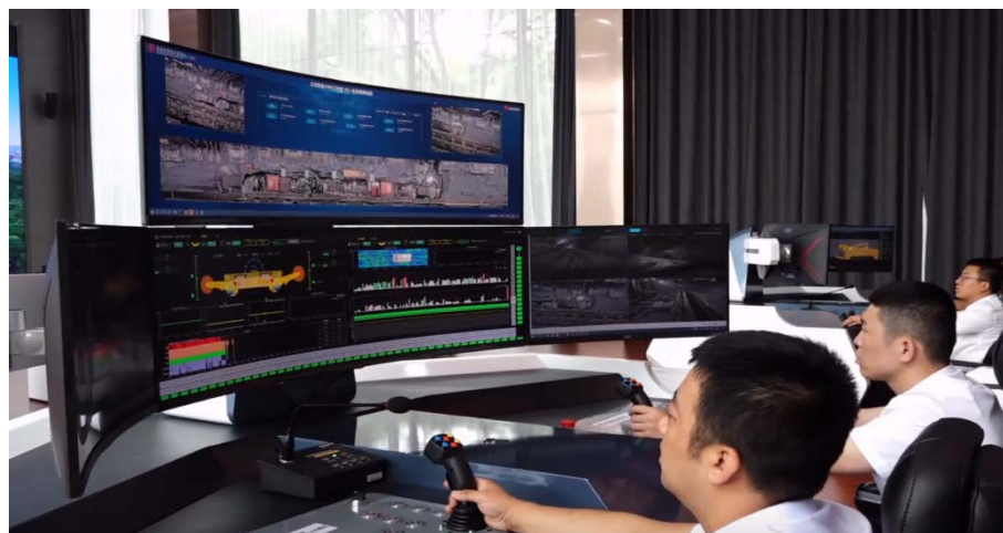
图 4 三元煤业 5G 远控采煤作业场景
