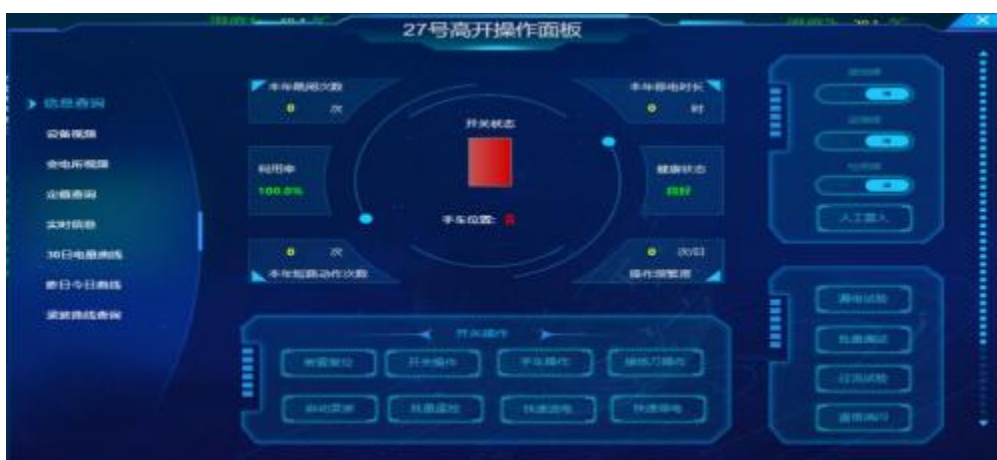
图3 远程漏电试验、一键式复送电、带电停电区域动态着色
