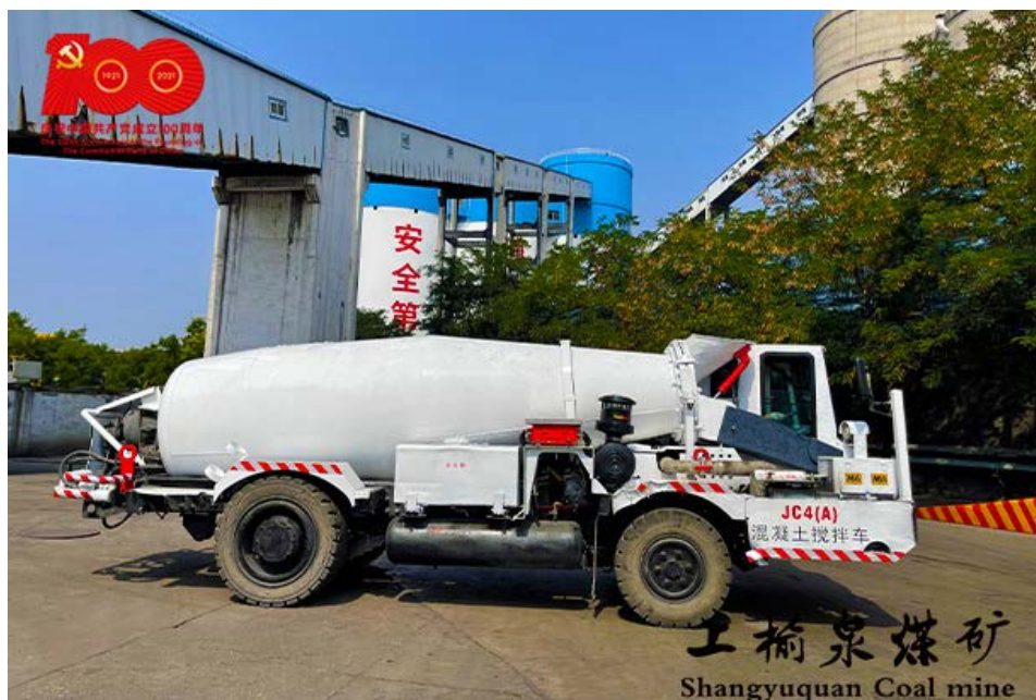
图7 混凝土搅拌运输车
