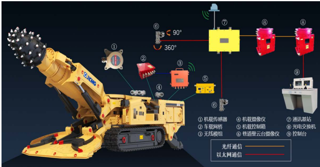
图3 智能化掘进系统
