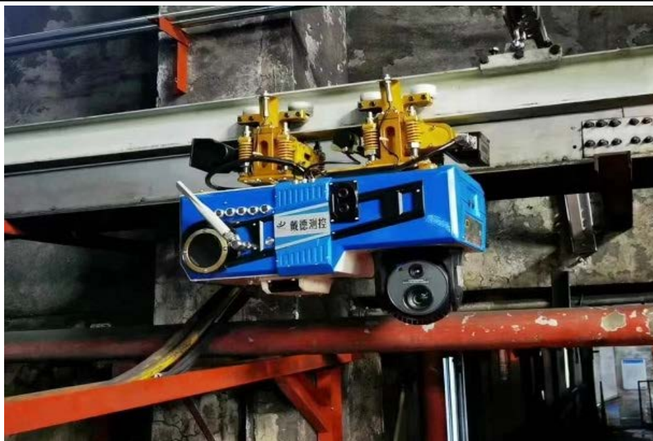
图 5 轨道式智能巡检机器人
