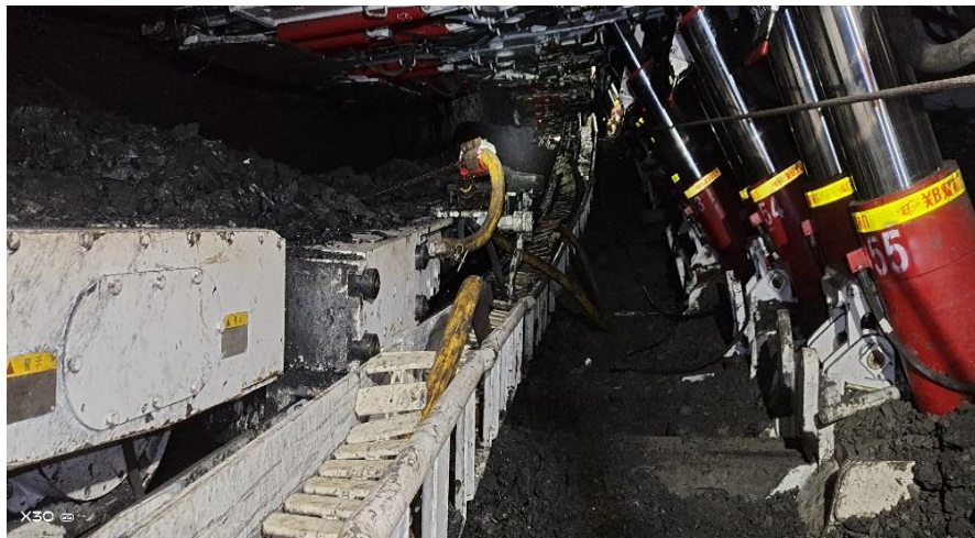
三软煤层开采（煤层软 f=0.3\sim 1 、顶板软 D\leq 3\text{MPa} 、底板软 q < 5\text{MPa} ）
