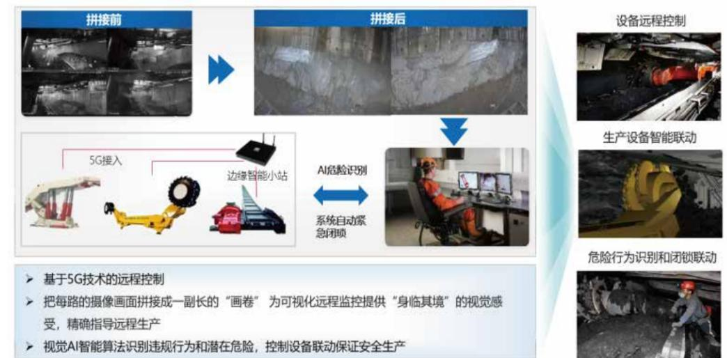
图1-2 综采面视频拼接示意图
