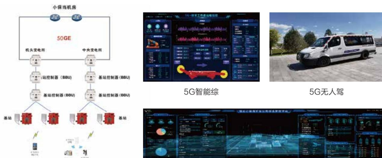
5G网络采用室外宏站与室内分布系统相结合，对办公区、生活区、生产区进行全覆盖；井下新建35套5G基站，主要覆盖副斜井、辅运大巷、掘进工作面胶运顺槽、综采工作面、中央变电所、中央水泵房；新建5G+MEC将UPF下沉到本地机房，对小保当5G专网数据进行本地闭环，数据不出厂区。基于5G通信技术，实现了无人驾驶、智能综采工作面等智能化应用。
