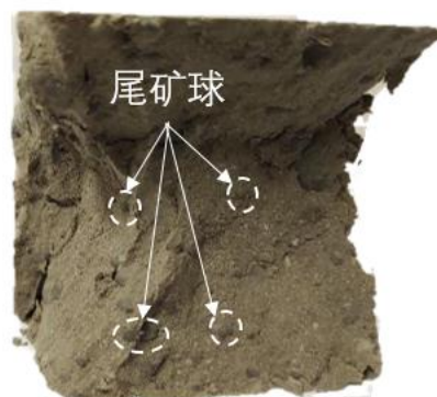
两相流场下料浆对尾矿球粒渗透作用及胶凝材料扩散规律示意图
