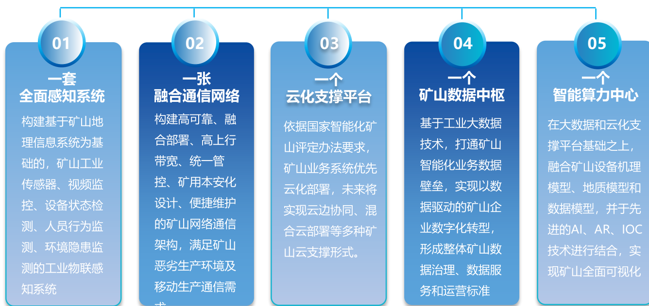
图：新华三智能化矿山“五个一”技术架构
