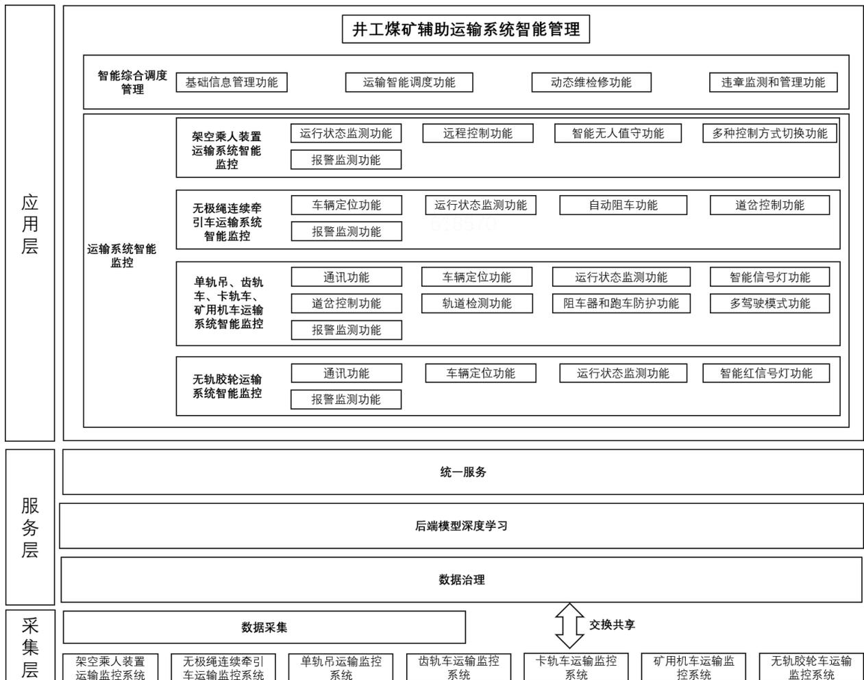
图 1 系统架构图
